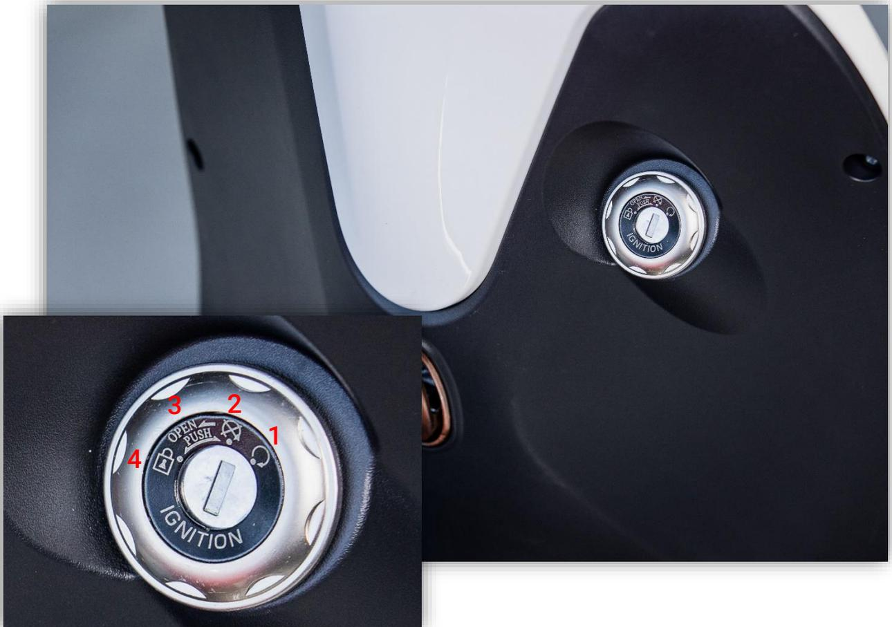
1. ROLLER ist an. Schalten Sie auf ON, nur wenn Sie abfahrbereit sind. Schalten Sie auf OFF, wenn Sie nicht mehr fahren und ziehen Sie den Schlüssel ab.
